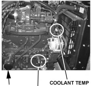
OIL FILTER P/N 06520097 COOLANT TEMP SENDING UNIT P/N 06505113
